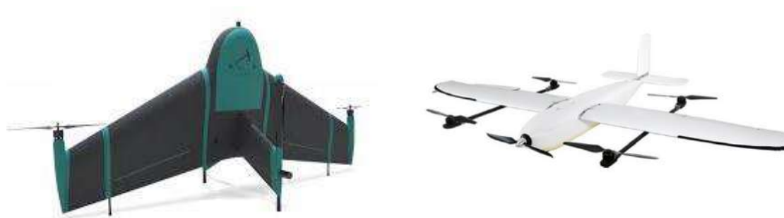
รูปที่ 2-13 ตัวอย่างอากาศยานไร้คนขับชนิดปีกตรึงขึ้นลงแนวดิ่ง (Fixed-Wing Hybrid)
