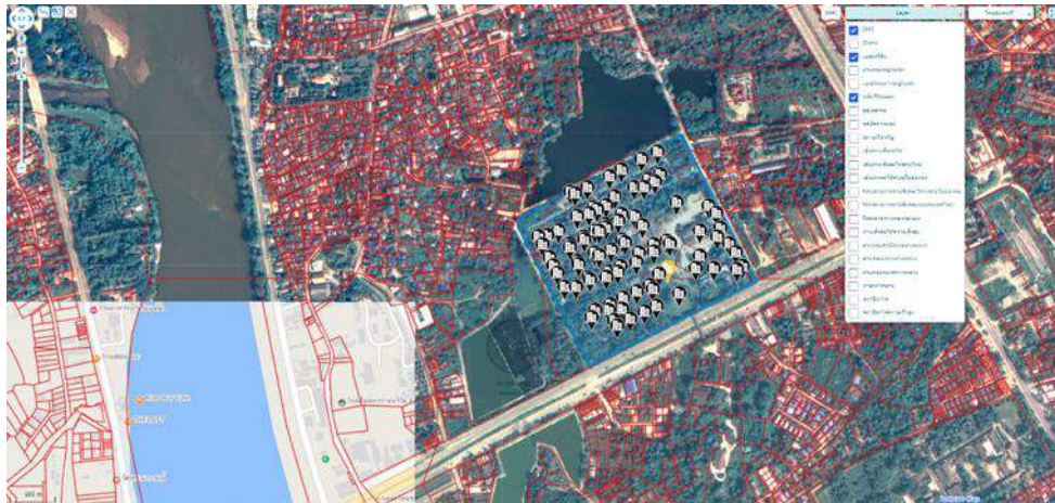
รูปที่ 2-59 การแสดงแนวเขตแปลงที่ดินแบบจุด (Point) และพื้นที่รูปปิด (Polygon) ร่วมกับภาพถ่ายทางอากาศเชิงเลข และระบบฐานข้อมูลรูปแปลงที่ดิน จากกรรมที่ดิน
