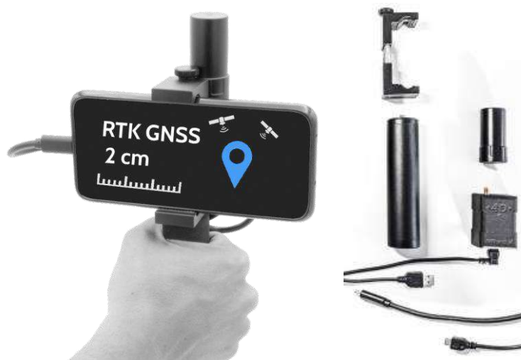
รูปที่ 2-19 ตัวอย่างอุปกรณ์ GNSS RTK แบบ Low Cost ที่ใช้งานกับ Smart Phone
