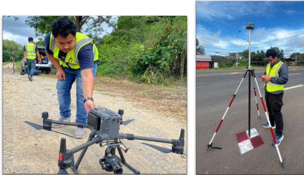
รูปที่ 2-60 การสำรวจข้อมูลที่ดินนอกเขตทางด้วยเทคโนโลยีอากาศยานไร้คนขับ (Drone)
